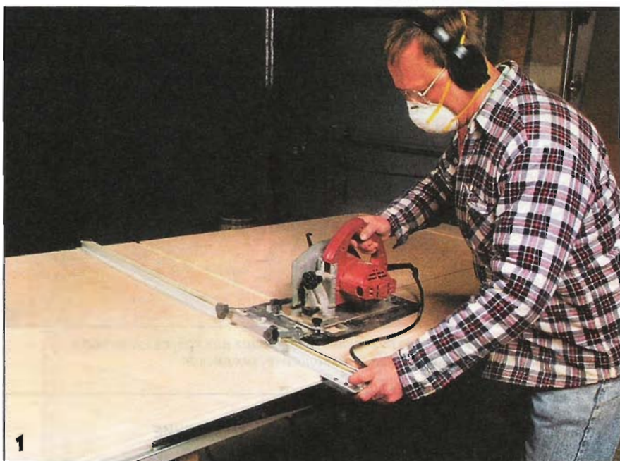
Трудоемкую работу по раскрою больших листов фанеры облегчают приспособления с направляющими для дисковой пилы. Т-образная рейшина с боковой роликовой направляющей позволяет раскраивать заготовки с высокой точностью.
