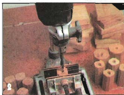
2 Отверстия под резьбовые втулки сверлят дрелью строго вертикально в центрах торцев заготовок, используя тиски и сверлильную стойку.
