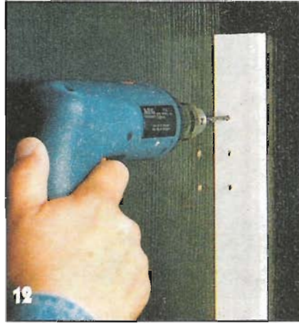
12 Отверстия под полкодержатели сверлят с помощью самодельного шаблона-кондуктора из твердой ДВП или фанеры.
