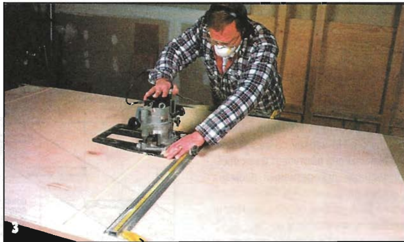
Чтобы с помощью Т-образной рейшины выбрать в панели прямоугольный соединительный паз, рейшину фиксируют с обоих концов и поддают фрезерную машинку, установленную на крепежной пластине вдоль ее линейки из алюминиевого профиля.
