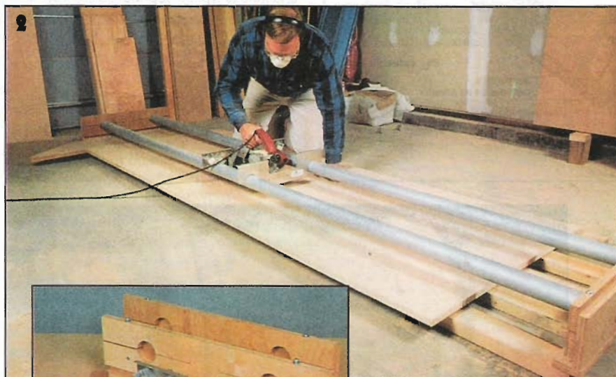
В таком приспособлении дисковая пила плавно перемещается вдоль направляющих из труб Ø50 мм. Таким образом можно пилить крупногабаритные листы и вдоль, и поперек.
