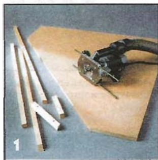
Кромки столешницы, изготовленной из плиты MDF, аккуратно скругляют. Снизу к ней крепят ребра жесткости из брусков сечением 20x20 мм.
