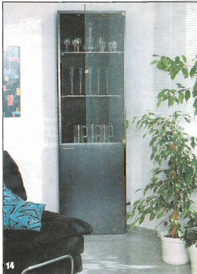
14 Небольшая опорная площадь не обеспечивает требуемой устойчивости шкафа. Поэтому его следует прикрепить к стене, например, с помощью уголка.
