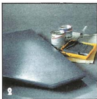
Платье столешницы, ее кромки и ребра жесткости грунтуют и покрывают лаком.
