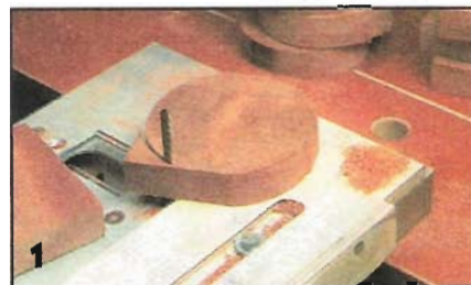
С помощью электролобзика или кольцевой пилы выкроить заготовку можно легко и быстро.
