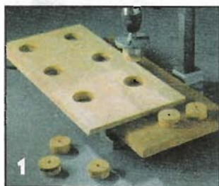
В наклонной стенке с помощью кольцевой пилы вырезают отверстия под горлышки бутылок.
