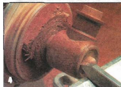
Торцевые выемки (например, у держателя мыла) выбирают только после склеивания шеек в розетку.
